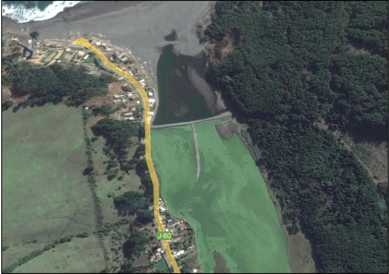
Figura 13. Cierre artificial del estuario en 2016. Observar la aparente acumulación de algas aguas arriba del cierre artificial. Las imágenes disponibles de Copernicus indican que el cierre probablemente se mantuvo desde finales de 2015 hasta junio de 2017. Fuente: GoogleEarth .
