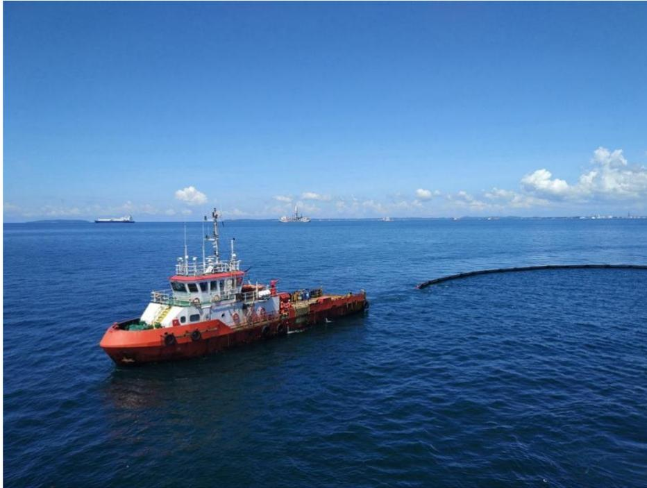
Foto 17 Una embarcación en alta mar realizando un ejercicio de respuesta a derrames de petróleo en medio del mar. La respuesta a los derrames de petróleo comprende un barco nodriza y un remolcador para cargar barreras flotantes de contención de derrames de petróleo. Mark\_vyz en Shutterstock.com
