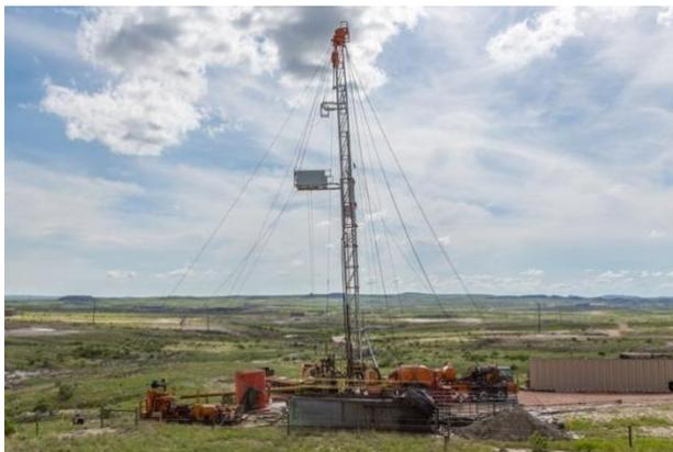
Foto 2 Unidad móvil instalada para una perforación exploratoria de hidrocarburos.
