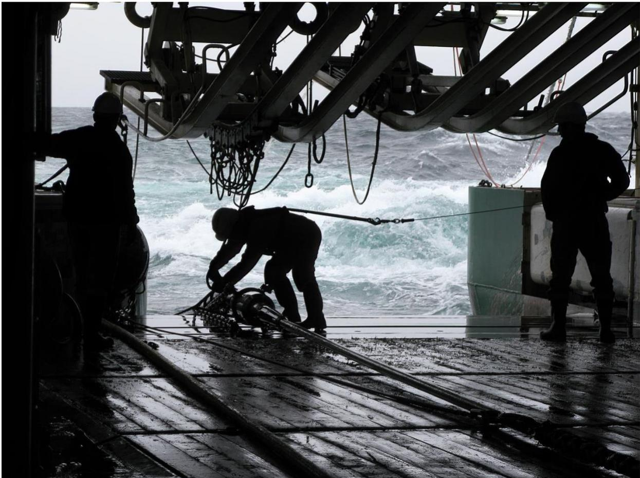
*Foto 7 Personal recuperando las fuentes de señales sísmicas (pistolas) desplegadas desde una embarcación de prospección sísmica costa afuera. Las fuentes de las señales sísmicas producen ondas acústicas submarinas con aire a alta presión. Jouni Niskakoski en Shutterstock.com*
