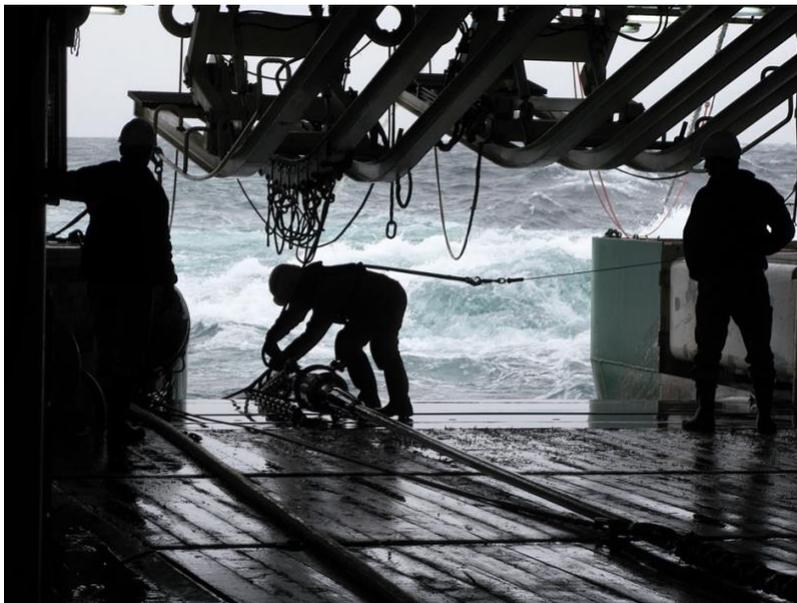
*Photo 7 Silhouettes de personnes récupérant des sources (canons) sur un navire de recherche sismique. Les sources sont utilisées pour produire des ondes sonores acoustiques sous-marines avec de l'air à haute pression. Jouni Niskakoski sur Shutterstock.com*
