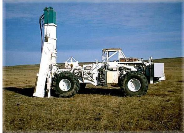
Photo 4 Foreuse montée sur buggy. Photo : District des Rangers de Duchesne.
