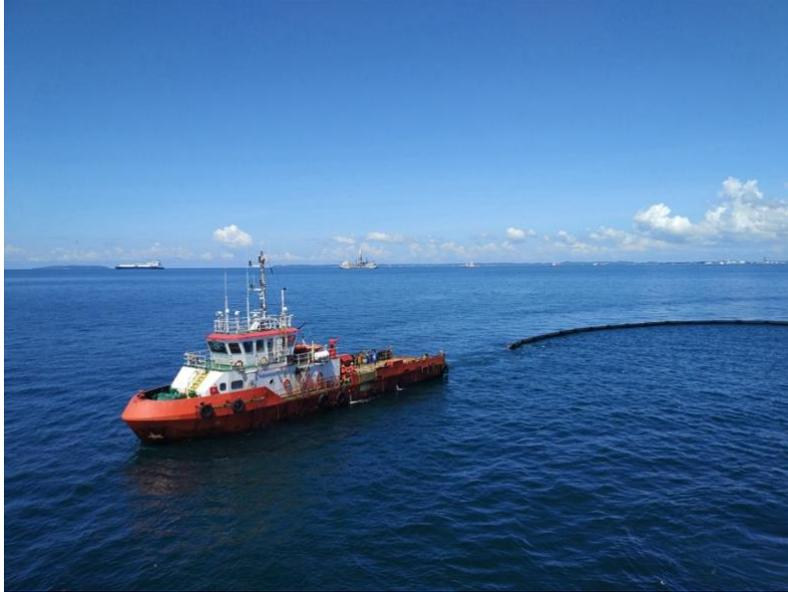
Photo 17 Un navire offshore effectue un exercice de lutte contre les déversements d'hydrocarbures au milieu de la mer. L'intervention en cas de déversement d'hydrocarbures comprend un bateau-mère et un bateau remorqueur pour transporter le barrage anti-pollution. Mark\_vyz sur Shutterstock.com
